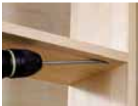
...ensamblando a continuación ambas piezas de trabajo con tornillos para madera.
