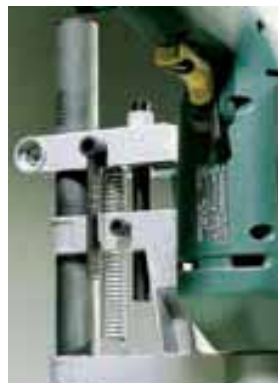
ajuste de profundidad de taladro por tope de profundidad
