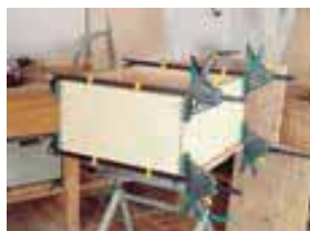
distanciadores desplazables protegen la pieza de trabajo y sirven de apoyo
