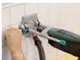
manilla adicional para la colocación en el punto exacto y contra el desplazamiento al taladrar
