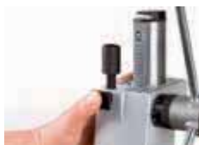
ajuste de profundidad por tope de profundidad de ajuste rápido
